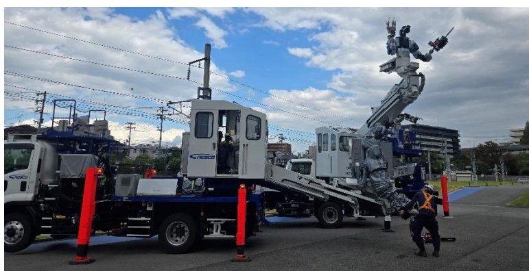
Z X - 3（量産型双腕型ロボット） Z X - 1 から小型・軽量化、ブーム長さを延長 2026年11月より使用開始予定
