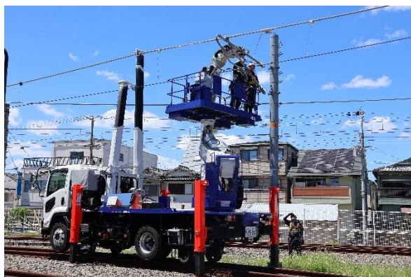
Z X - 2（重作業用単腕型ロボット） 重量物作業をアシスト （最大120kg 把持可能） 2026年10月より使用開始予定
