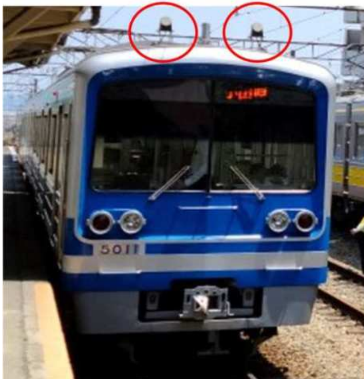
車上無線機アンテナ（赤丸部）
