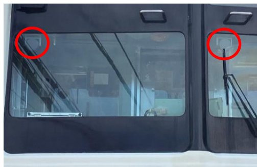
C B T C車上アンテナ（赤丸部）
