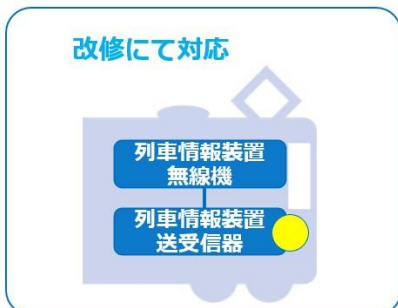
列車情報装置をベースとした無線式列車制御 (C B T C) システム
