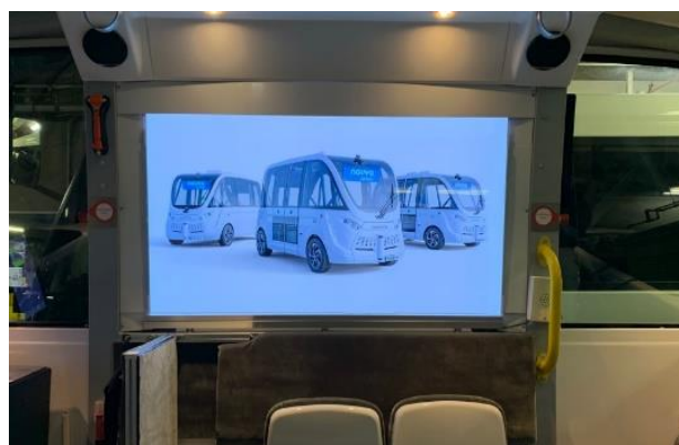
車室内への半透過型ディスプレイの設置
