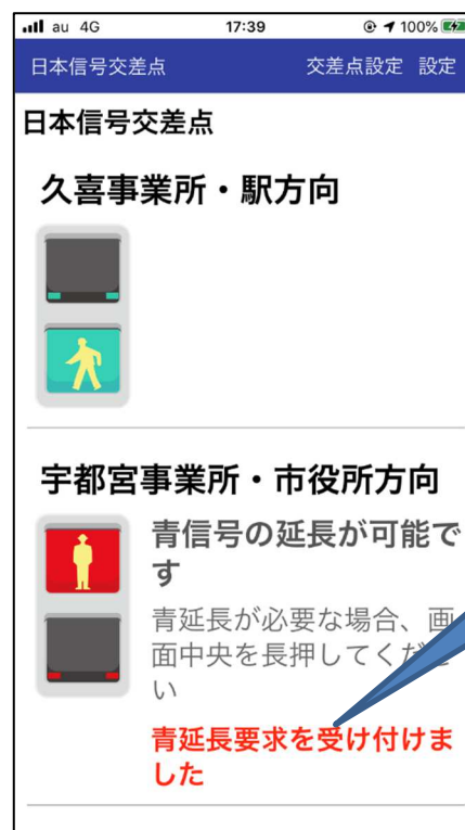
図 5.3 歩行者押ボタン要求支援サービス（青延長要求機能）
