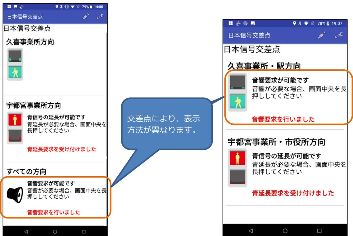
図 5.4 歩行者押ボタン要求支援サービス（音響要求機能）
