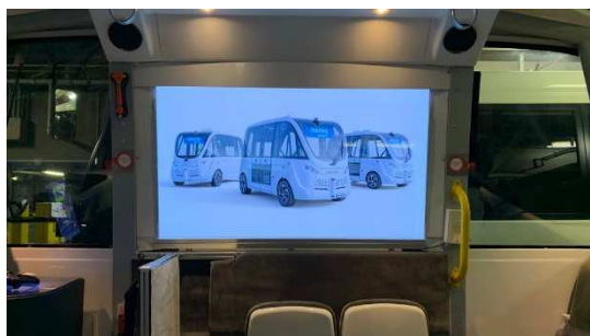
車室内への半透過型ディスプレイの設置
