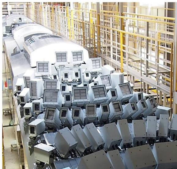
電気設備撮像装置（屋根上カメラ）
