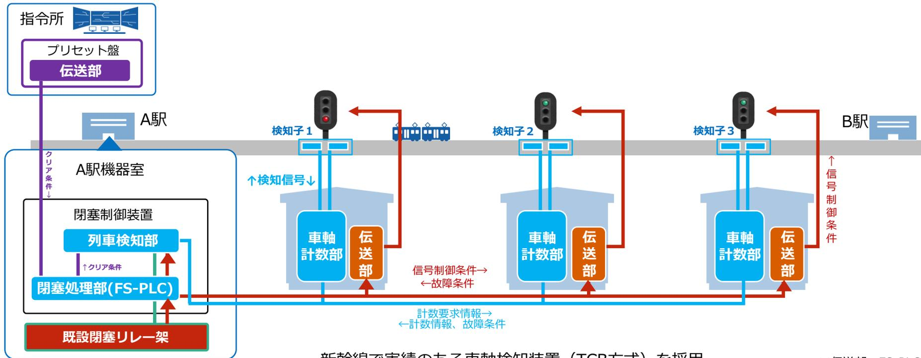
新幹線で実績のある車軸検知装置 (TCB方式) を採用
