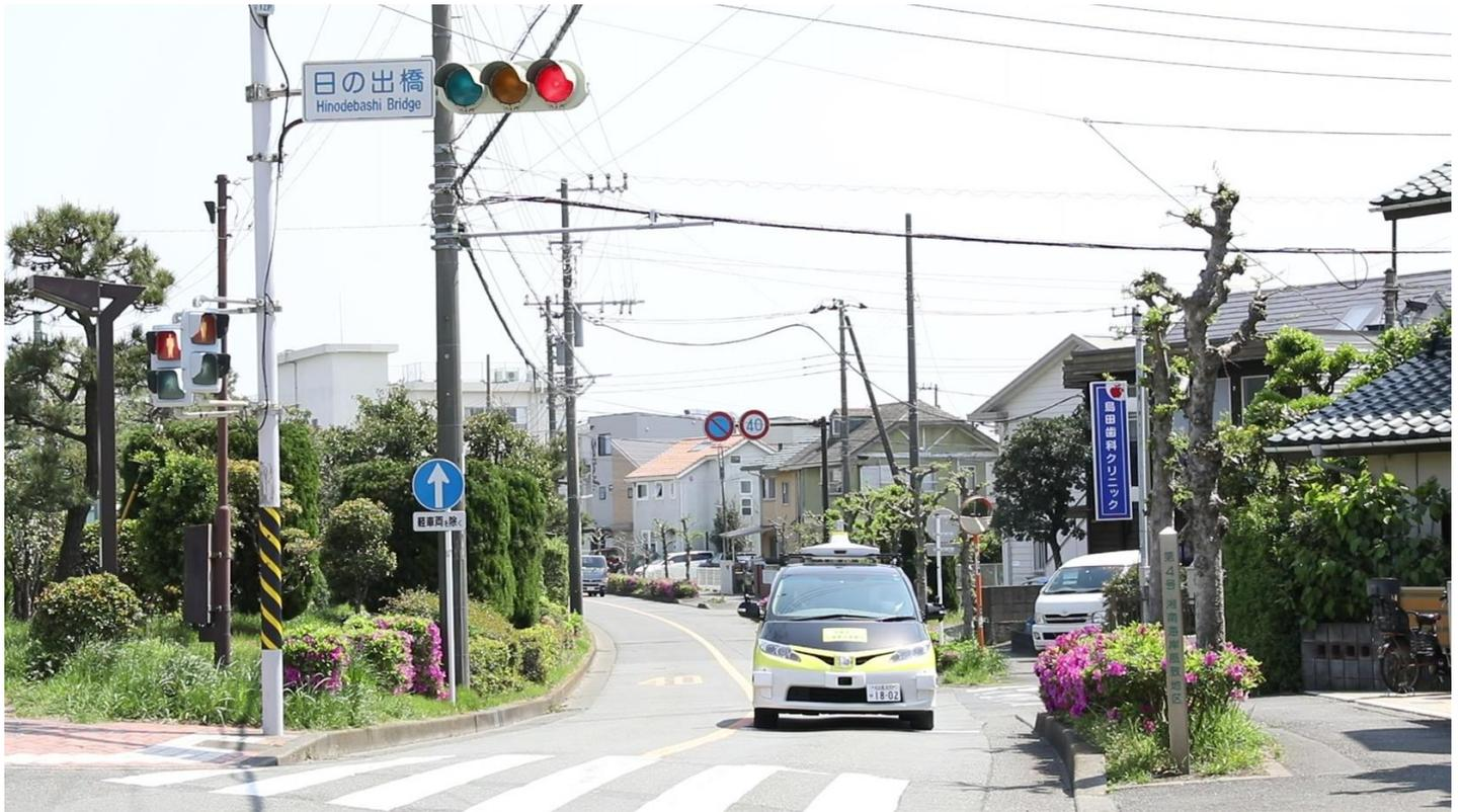
信号制御機に日本信号の専用無線装置を取り付け、リアルタイムに信号の灯色や残り時間などの情報を自動運転車両へ送ります。信号情報を受けた車両は、その自動運転システムによって「進む」か「停止」かの制御を行います。
