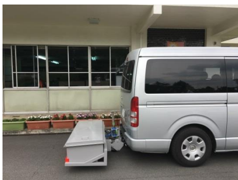
空洞探査車用レーダシステム取付例
