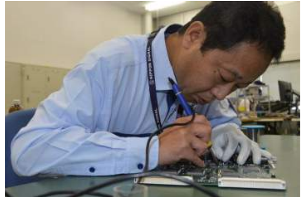
はんだ付け作業の様子
