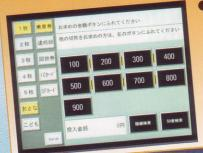
●大型カラーLCDのタッ チパネルを採用。大き なボタンではっきり表 示します。タッチ面には 強化ガラスを使用して います。
